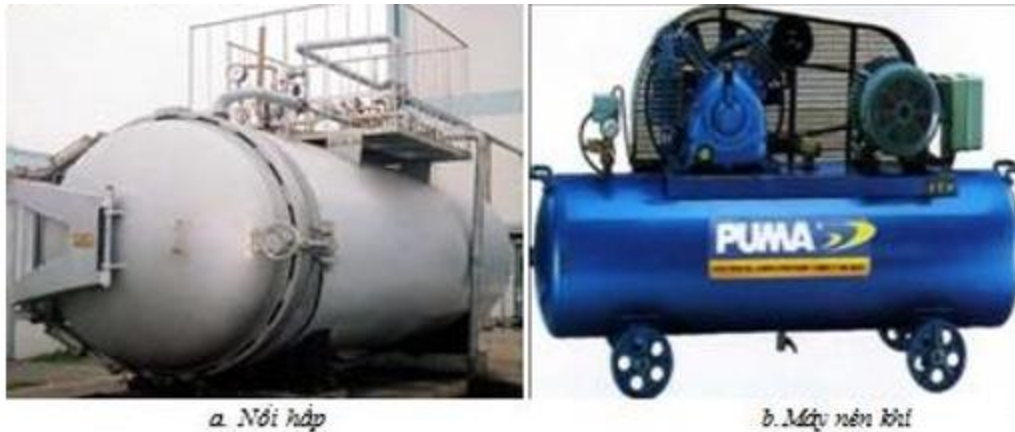
Hình 2.1. Nồi hơi và thiết bị áp lực
