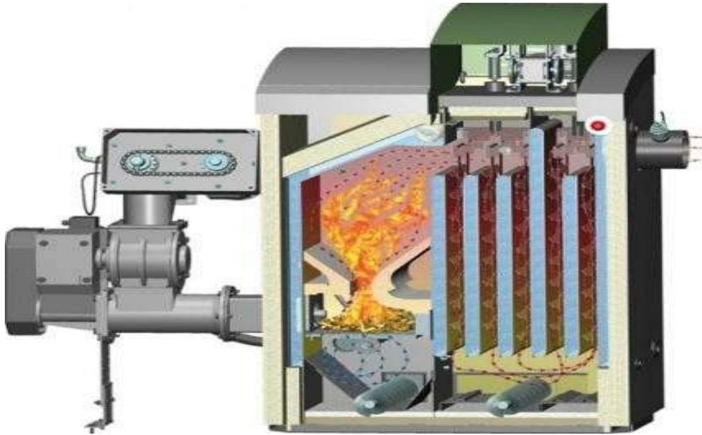
Hình 2.2. Nồi hơi đốt than ghi tĩnh
